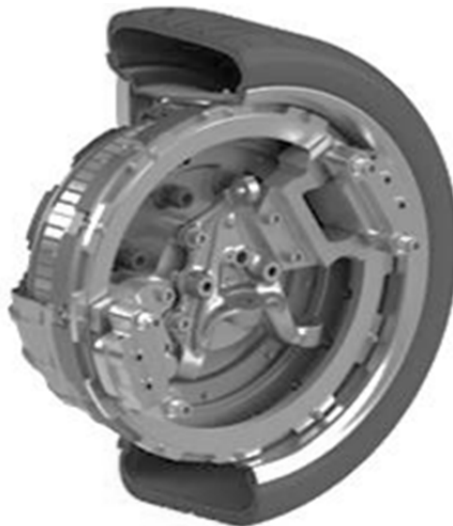
Рис. 1 – Приклад виконання опорного приводного колеса з вбудованим тяговим електродвигуном
