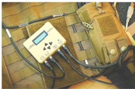
Рис. 4. Диспетчер електроживлення Vest Power Manager 402 американської компанії Protonex
